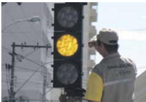
A cidade de São Carlos está vivenciando, desde o mês de janeiro, uma nova experiência na área de trânsito: um novo modelo de semáforo construído a partir de um conjunto de diodos emissores de luz (LEDs) de alta potência e com grande eficiência óptica.
