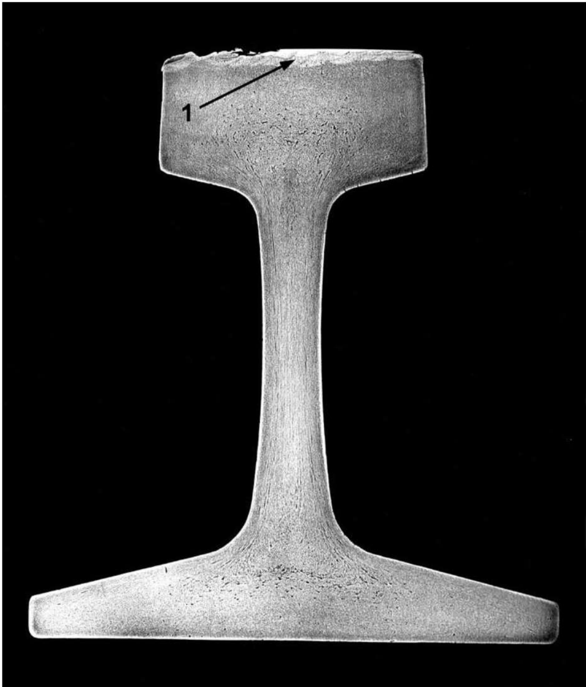
Figura 2. Reparación por soldadura (ver flecha 1) e influencia del calor de la soldadura en la microestructura del riel, mostrando leve segregación. Reactivo de yodo.
