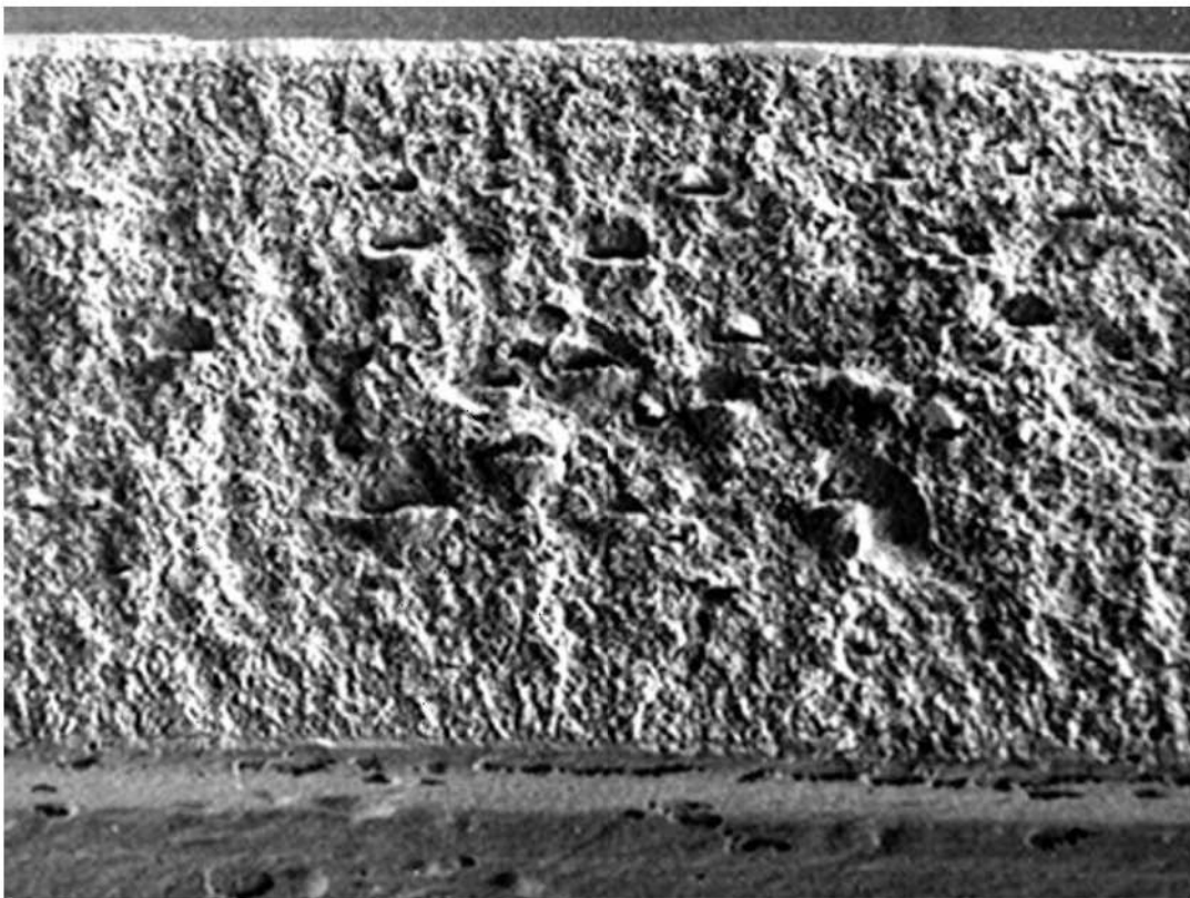
Figura 2. Superficie de la fractura. Cavidades provocadas por la rotura de inclusiones alargadas en la sección normal a la superficie de la fractura. MEB-SEI. 100X.
