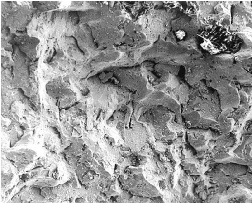
Figura 4. Aspecto de la fractura junto a la región II de la figura 3. Fractura intergranular con innumerables grietas, característica de la falla ocurrida por acción del hidrogeno por medio de la formación de escamas. MEB-SEI. 100X.
