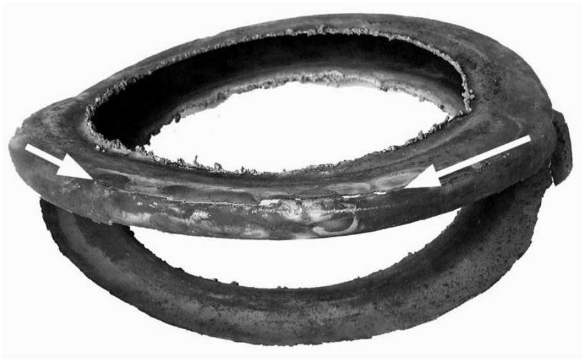
Figura 3. Aspecto del fuelle de \text{Ø } 8'' . Se nota la existencia de grietas paralelas a la rotura observada (flechas).
