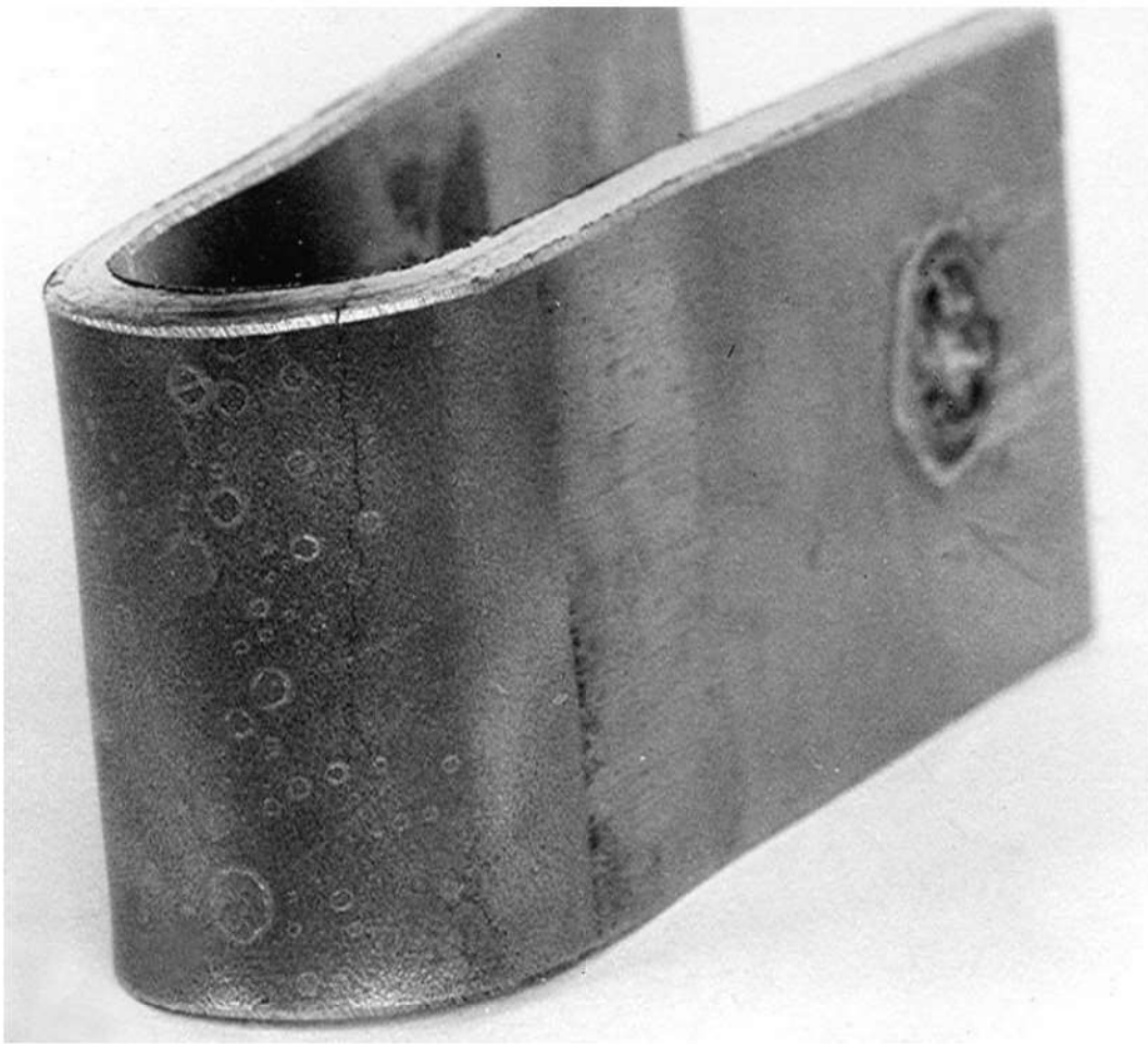
Figura 7. Aspecto del cuerpo de prueba mantenido en agua de mar sintético después de la retirada del perno de fijación. Agrietamiento intergranular.
