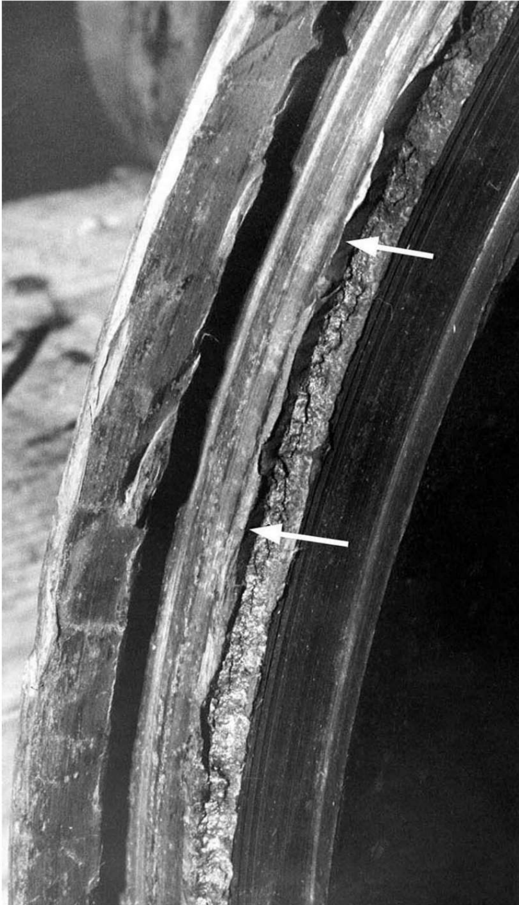
Figura 11. Aspecto de la superficie de la fractura de la primera rueda de la turbina. Las flechas indican la región de arrancamiento final, por cizallamiento radial, en consecuencia de esfuerzos centrífugos.
