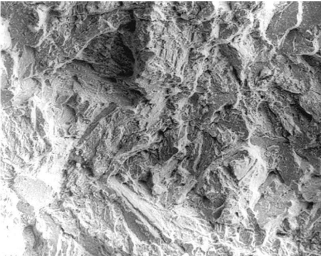
Figura 4. Aspecto da fractura de uno de los fragmentos do cilindro II. Fractura transgranular predominante por cuasiclivaje en toda la sección, excepto junto a la superficie (ver figura 5). MEB, 300X.
