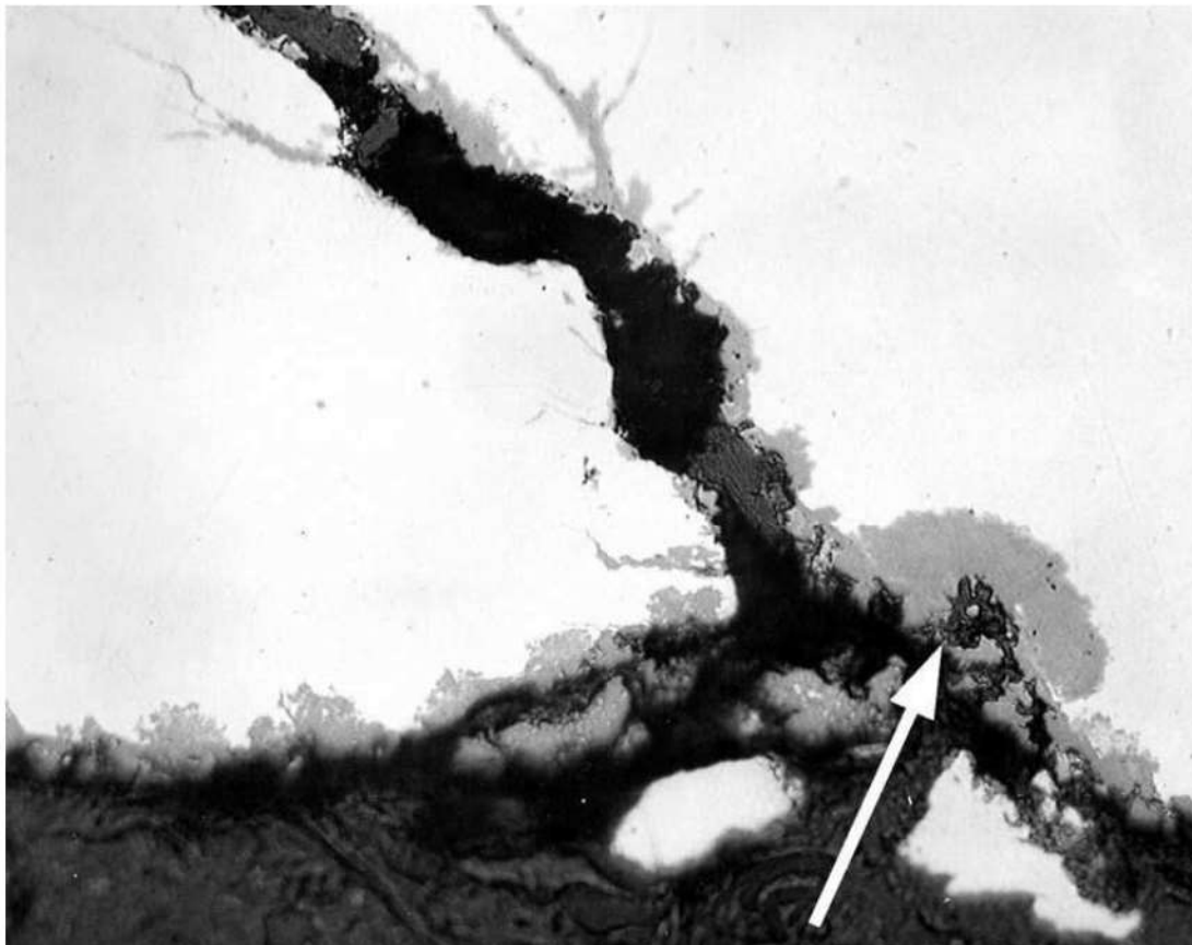
Figura 15. Detalle de la figura 12, evidenciando la presencia de óxido (flecha) en las caras internas de las grietas. 1500X.
