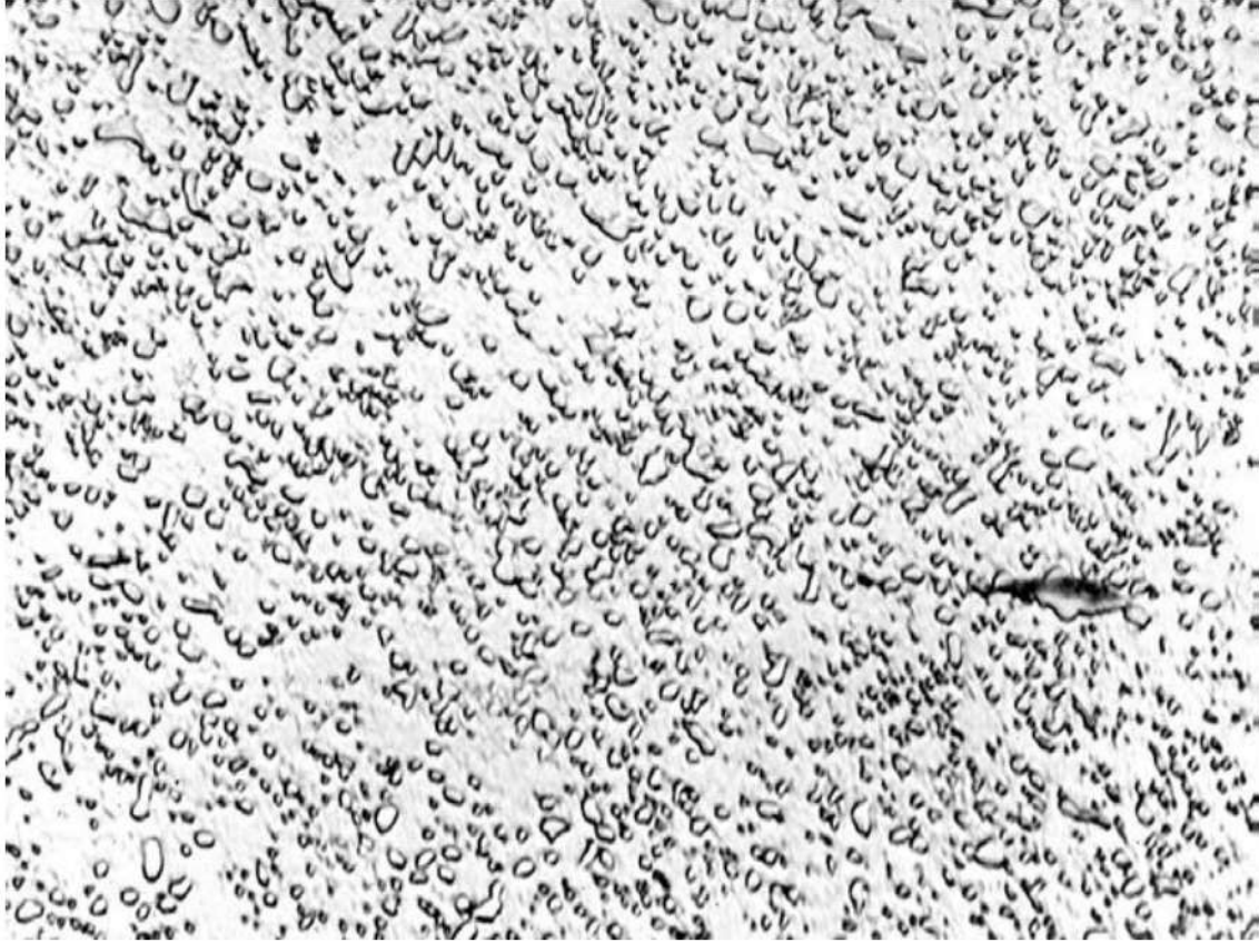
Figura 1. Barra de acero sueco. Glóbulos de cementita sobre un fondo de ferrita. Microestructura de acero completamente esferoidizado. Reactivo de ácido nítrico.1000X
