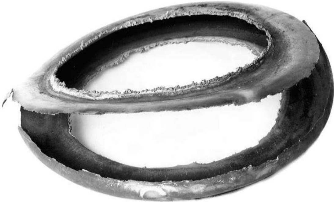
Figura 1. Aspecto del fuelle de \text{Ø } 8'' recibido.
