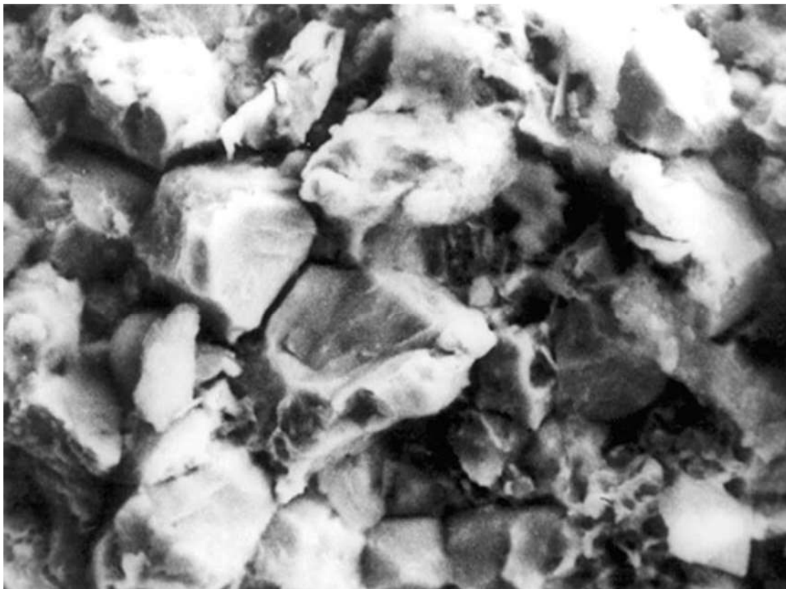
Figura 10. Muestra A. Aspecto de la superficie de fractura en la región de inicio de fractura. Fractura predominantemente intergranular. MEB-SEI. 1000X.
