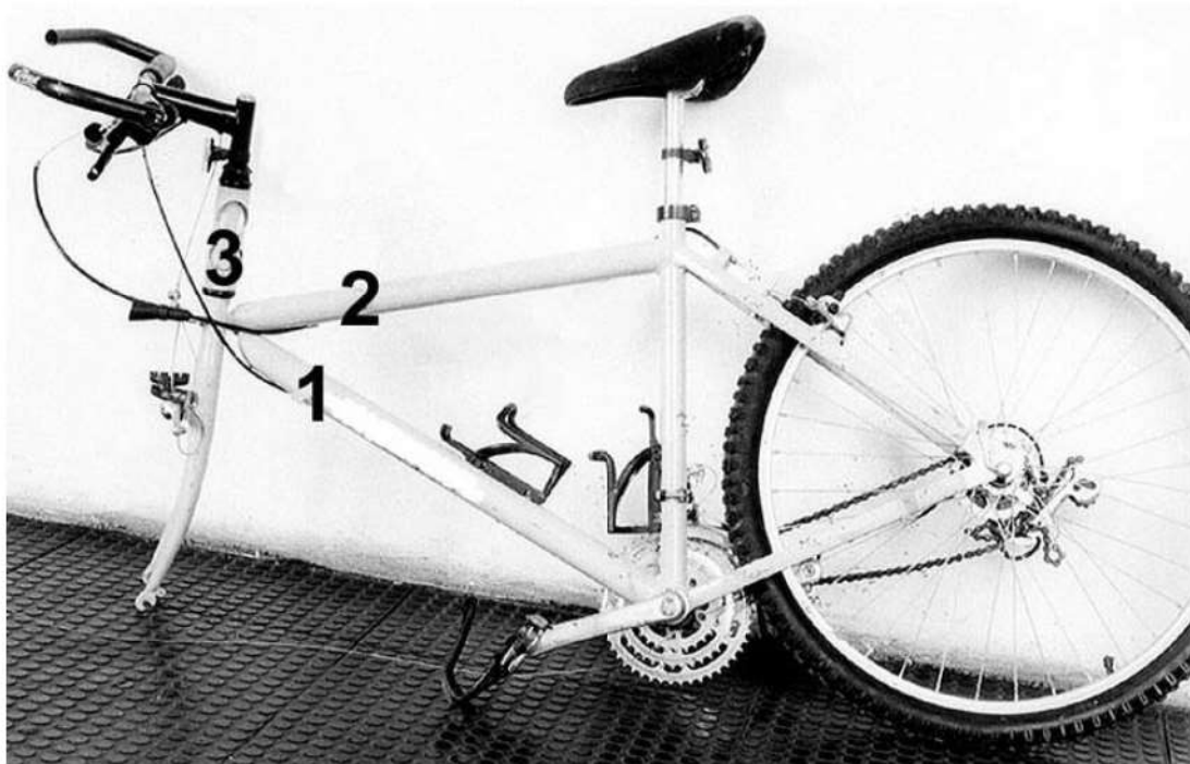
Figura 1. Aspecto de la bicicleta recibida, mostrando que la rotura del cuadro ocurrió en las juntas de la soldadura de unión de los tubos inclinado (1) y horizontal (2) al tubo pivote del conjunto trinche/manubrio (3).
