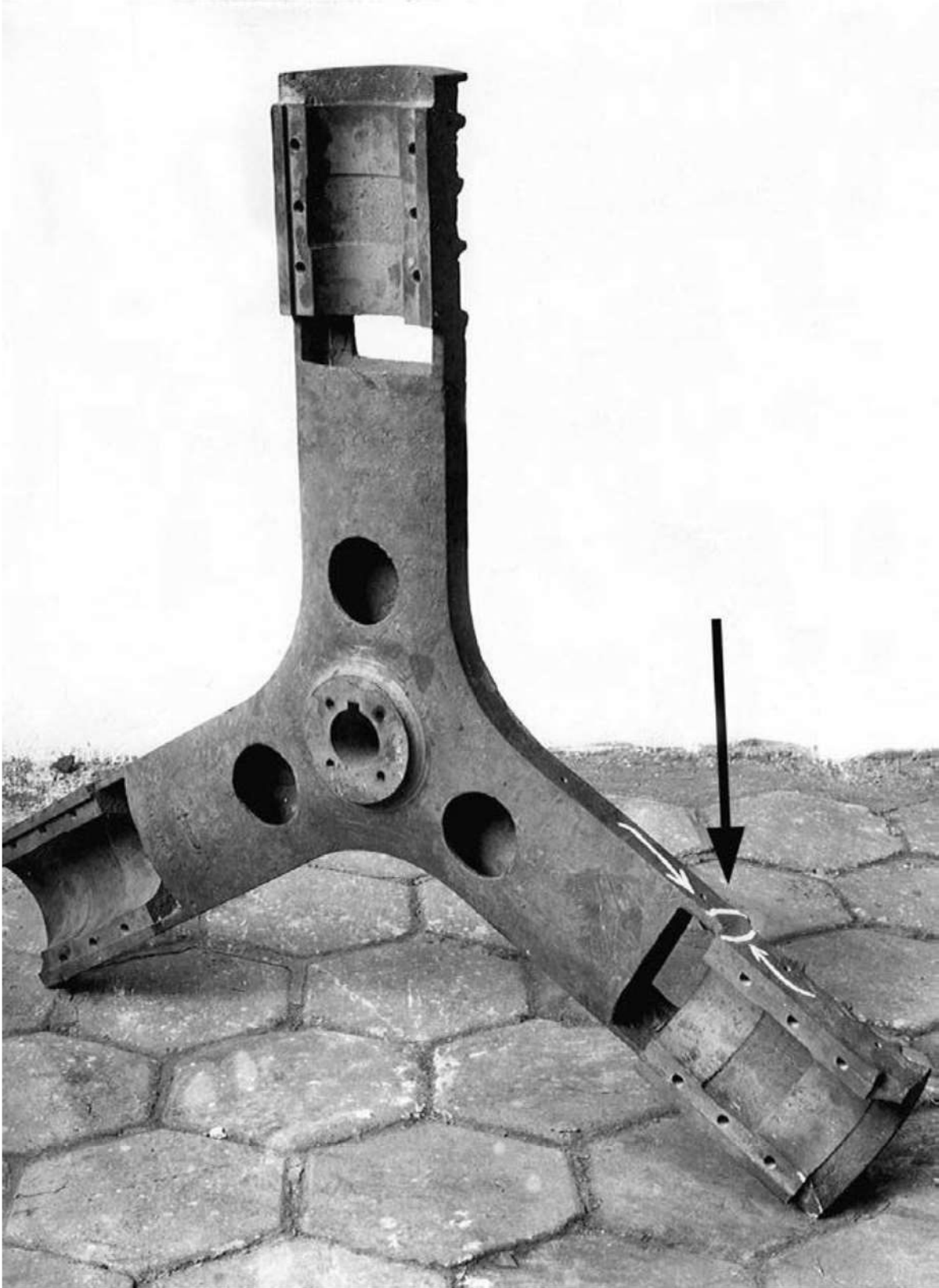
Figura 1. Aspecto de la pieza “Y” (cubo del ventilador). La flecha muestra la región agrietada.
