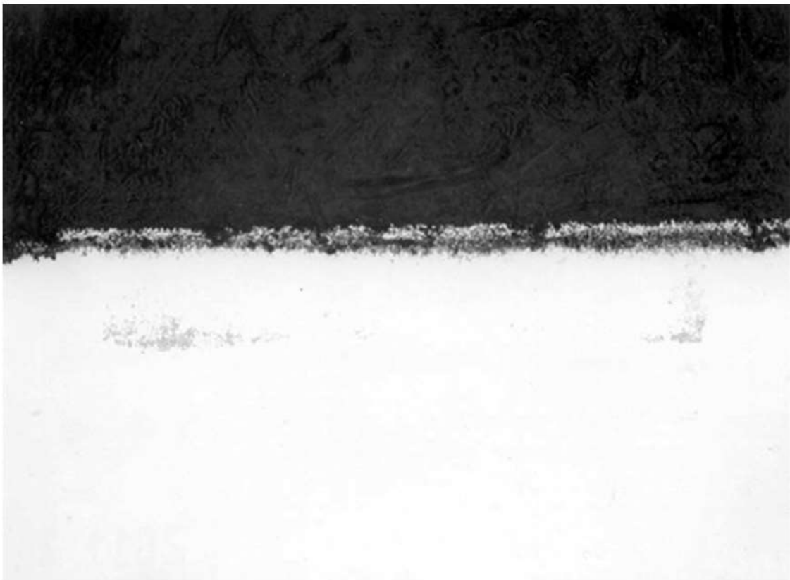
Figura 8. Cilindro V. Aspecto de la microestructura del material del cilindro junto a la superficie. Sin ataque, 100X.
