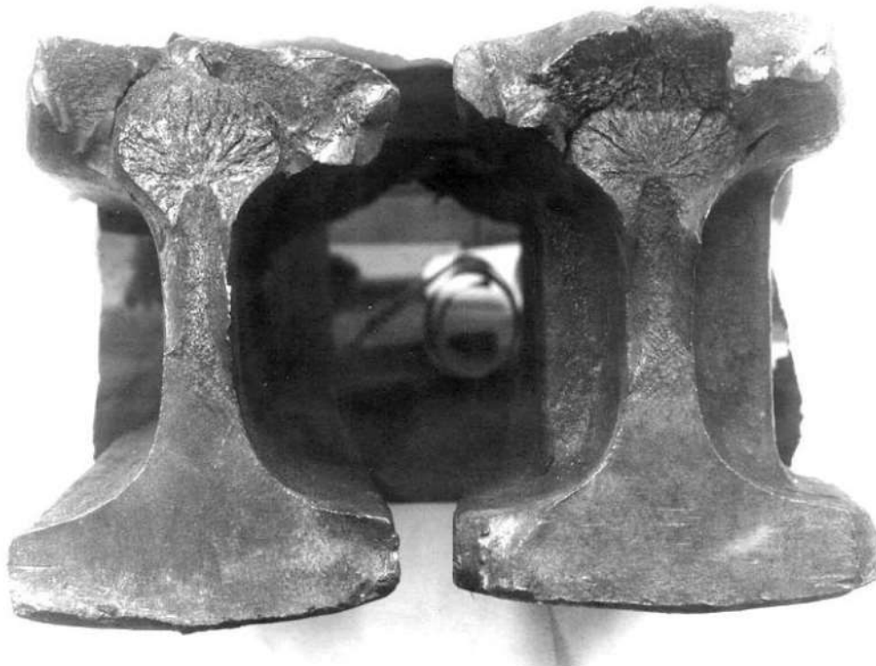
Figura 1. Aspecto de la fractura. Rotura de desarrollo progresivo (fatiga) iniciada en el borde inferior del perfil. Rotura final con desprendimiento, presentando acentuada deformación plástica (borde superior).
