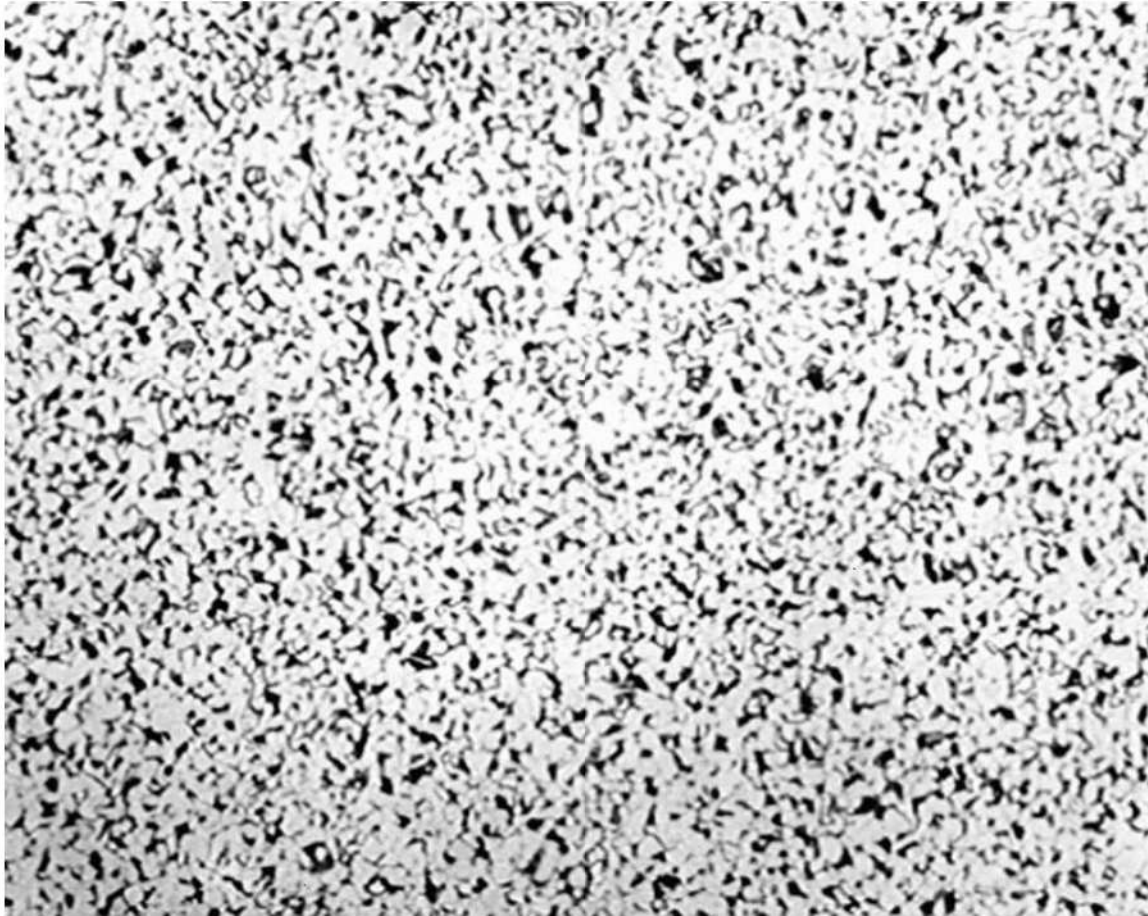
Figura 17. Sección longitudinal. Microestructura del tubo lejos de la región estrangulada. Granos de ferrita y colonias de perlita. Estructura de acero de bajo contenido de carbono normalizado. Nital. 100X.
