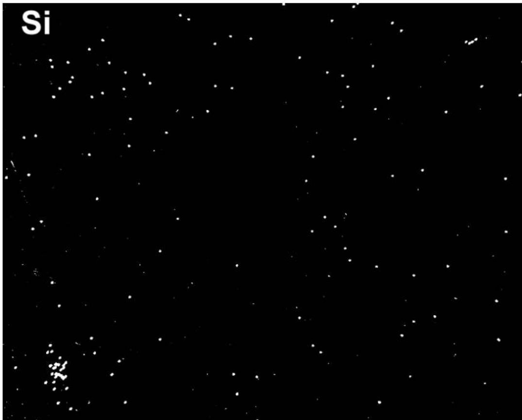
Figura 5. Imagen de rayos X del elemento silicio línea K, obtenida en el mismo campo de la figura 4.
