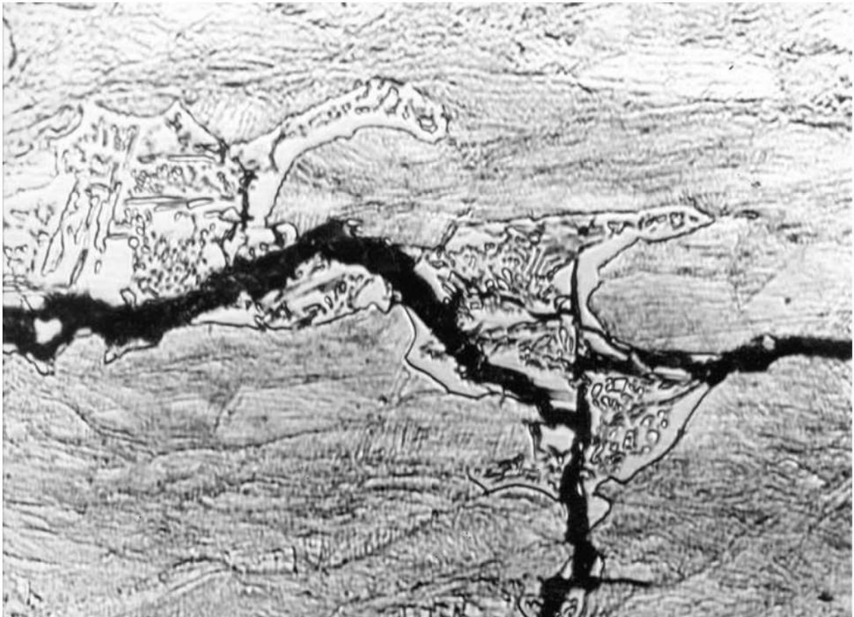
Figura 2. Detalle de grieta atravesando un área de eutéctico. Reactivo de per clorito de ácido férrico. 1000X.
