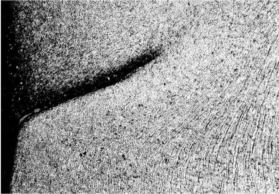
Figura 5. Navaja en estado bruto de forjamiento. Sección longitudinal. Se notan las deformaciones internas que el doblar produjo en el interior del material. Reactivo ácido nítrico. 60X.
