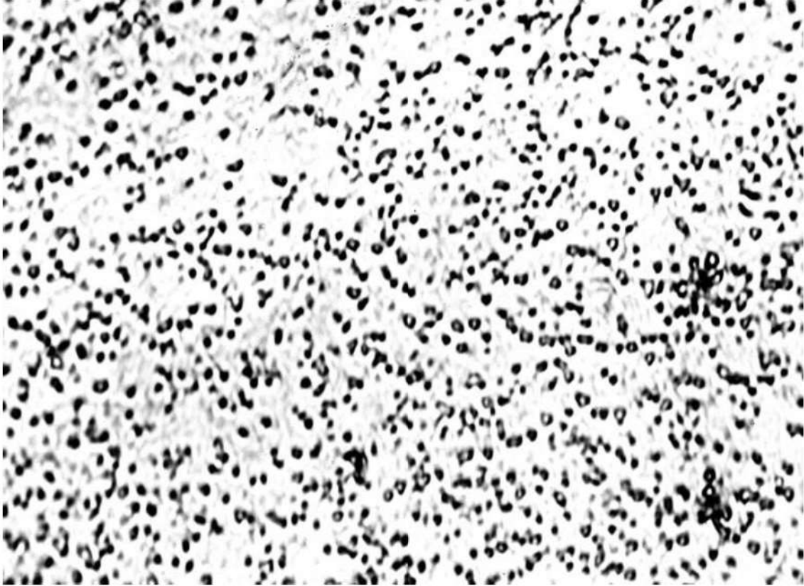
Figura 1. Material original. Carburos sobre matriz ferrítica. Microestructura del acero inoxidable martensítico, bien recocido, Reactivo de perclorito de hierro. 1000X.
