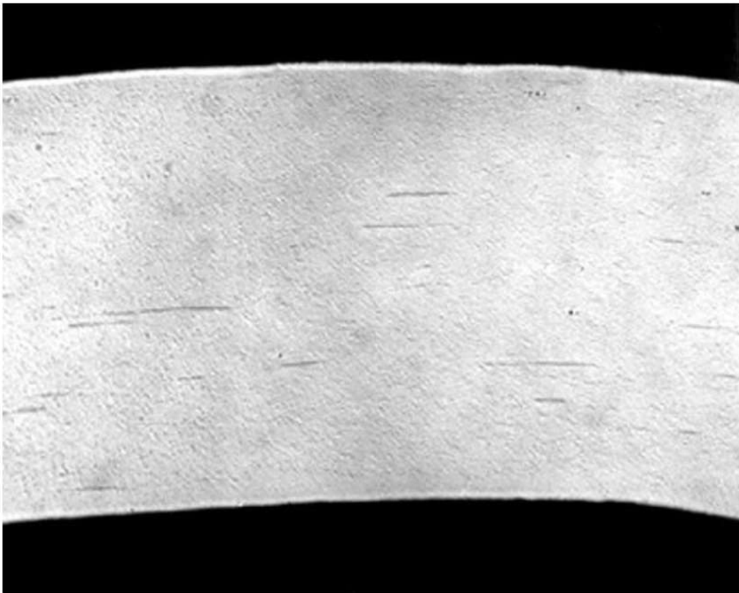
Figura 4. Sección transversal a la fractura, sin ataque. Aspecto de la microestructura del material del resorte. Capa superficial electro depositada y numerosas inclusiones. 100X.
