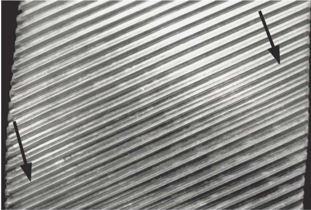
Figura 7. Dientes de engranaje que se acopla con el piñón de la turbina. Las flechas indican desgaste acentuado en una de las extremidades de los dientes, característico del engranaje defectuoso (más fácilmente detectable inclinándose la fotografía para observación a lo largo de los dientes).
