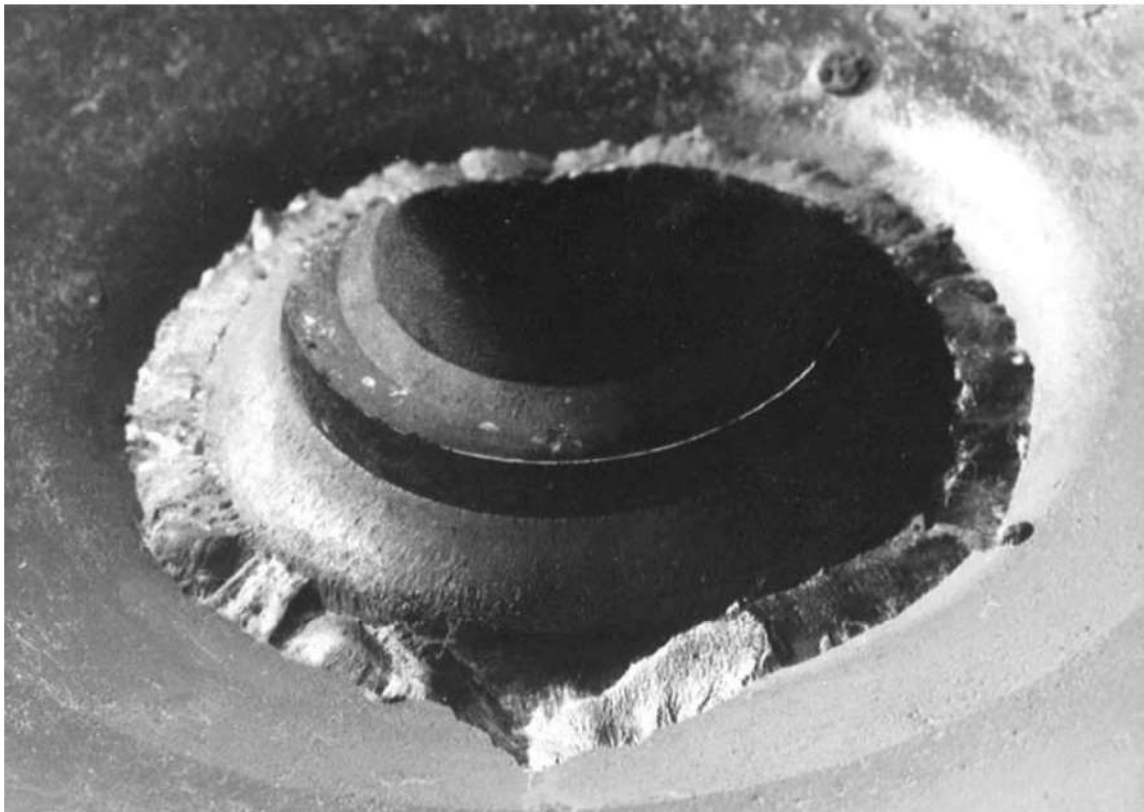
Figura 6. Detalle de la figura 5, mostrando el aspecto de la fractura visto del lado de la brida.
