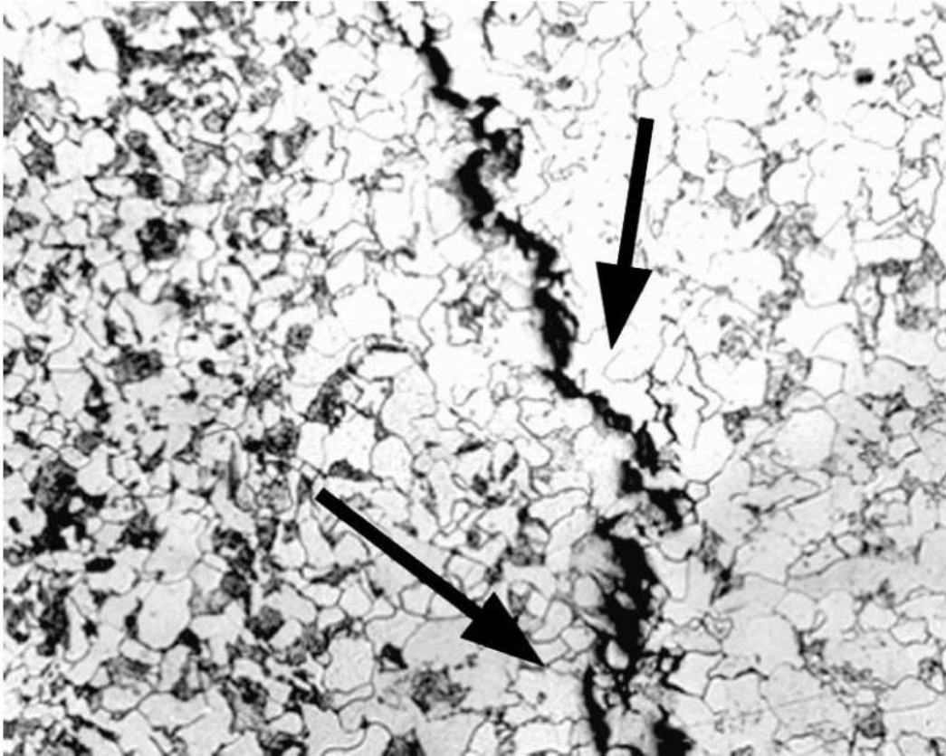
Figura 10. Sección transversal del espejo en la región agrietada. Ferrita (fase clara) y perlita (granos oscuros). Grietas intergranulares e intensa descarburación (flechas) a lo largo de las mismas. Nital. 100X.
