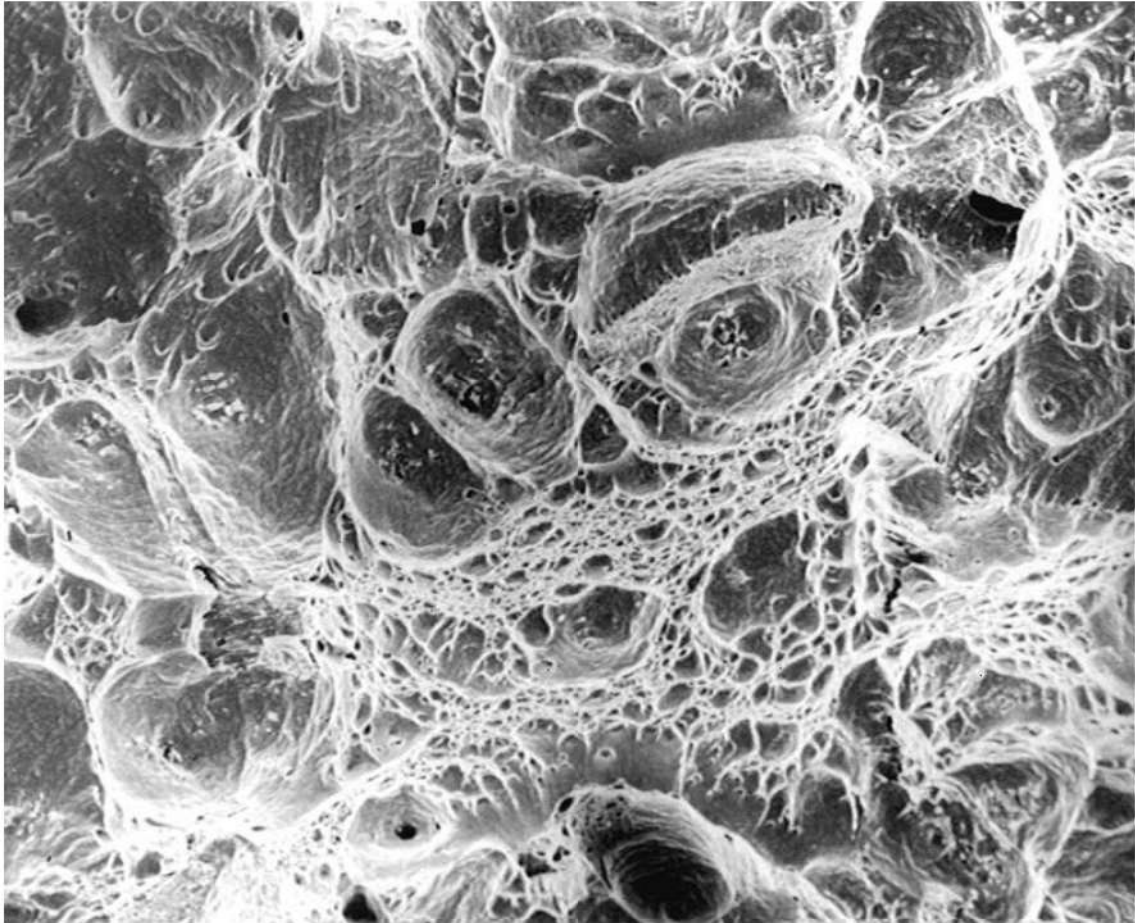
Figura 9. Muestra del tarugo A, sometido al tratamiento térmico "a" (solubilización a 815°C por una hora seguida de enfriamiento en aceite). Fractura dúctil con alvéolos, presentando una distribución bimodal. MEB. 1000X.
