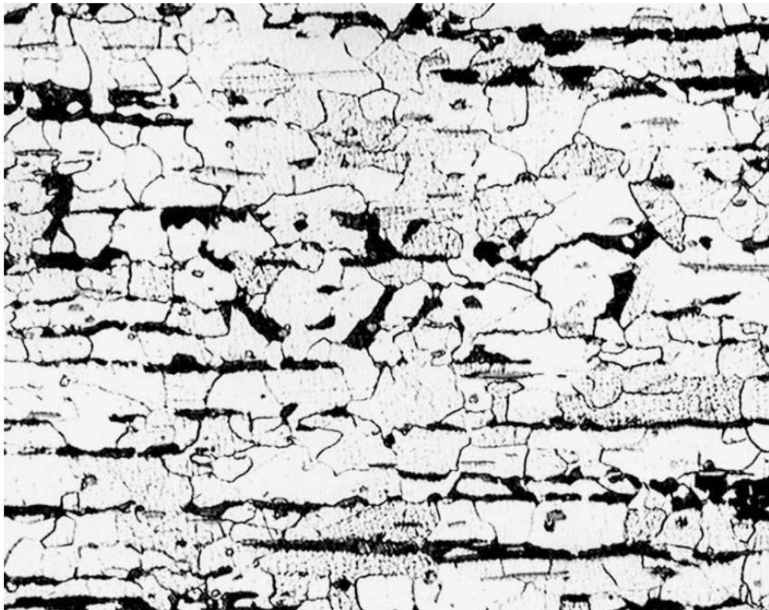
Figura 2. Sección longitudinal. Microestructura del acero resulfurado, de bajo contenido de carbono, en estado recocido. Reactivo de ácido nítrico. 200X.
