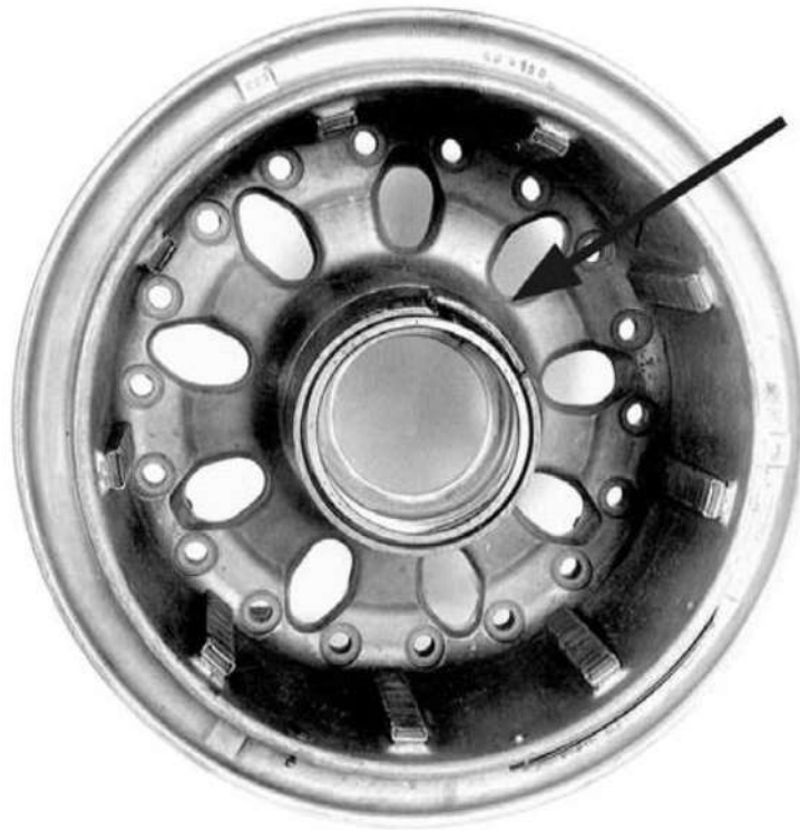
Figura 1. Aspecto en la rueda como recibida. La flecha indica la región fracturada.
