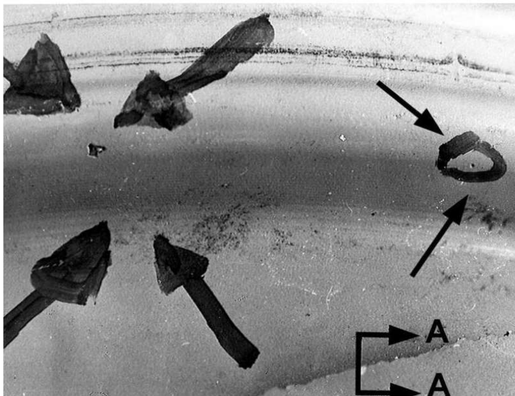
Figura 3. Aspecto de la rueda dañada, mostrando porosidad en la superficie del aro (flechas). El corte A-A indica la posición donde fue efectuado el examen metalográfico.
