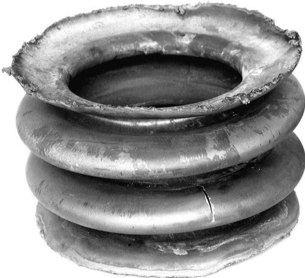
Figura 2. Aspecto del fuelle de \text{Ø } 6'' recibido.
