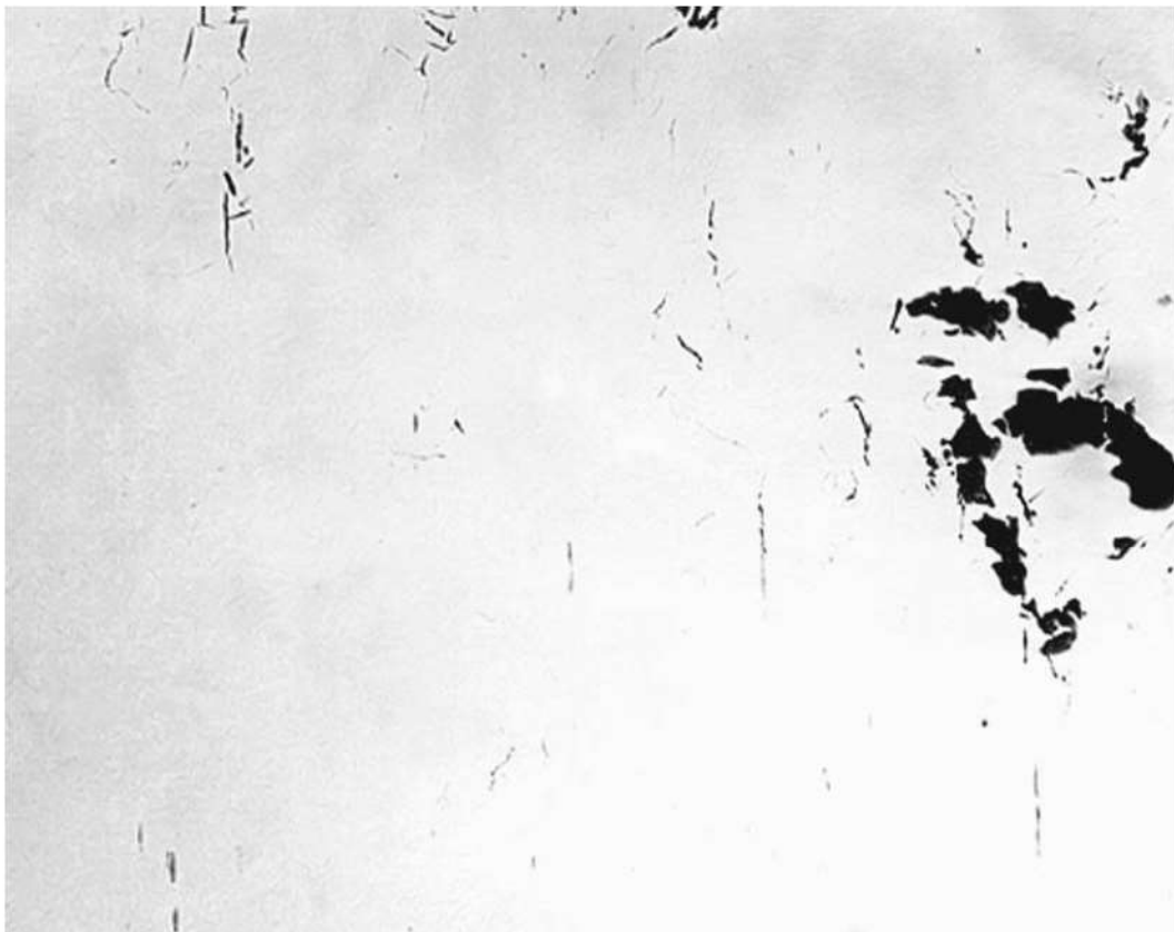
Figura 6. Sección paralela a la superficie de la fractura. Innumerables grietas, inclusiones y porosidades. 50X.
