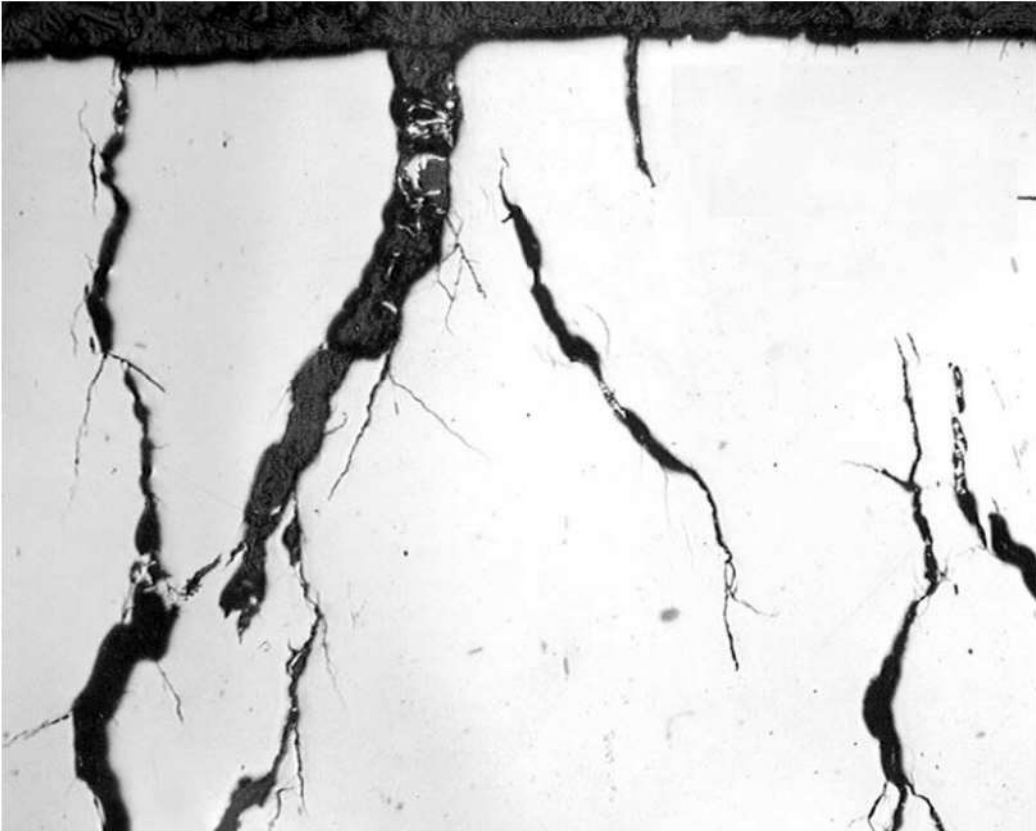
Figura 20. Sección transversal. Aspecto de las grietas radiales en la sección A-A indicada en la figura 9. 50X.
