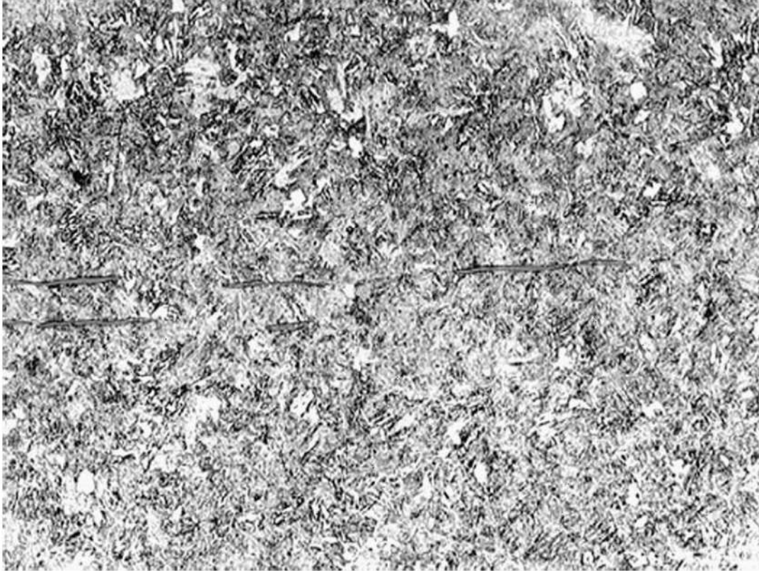
Figura 1. Microestructura de la muestra A. Martensita revenida e inclusiones alargadas de sulfuro. Sección longitudinal. Nital. 400X.
