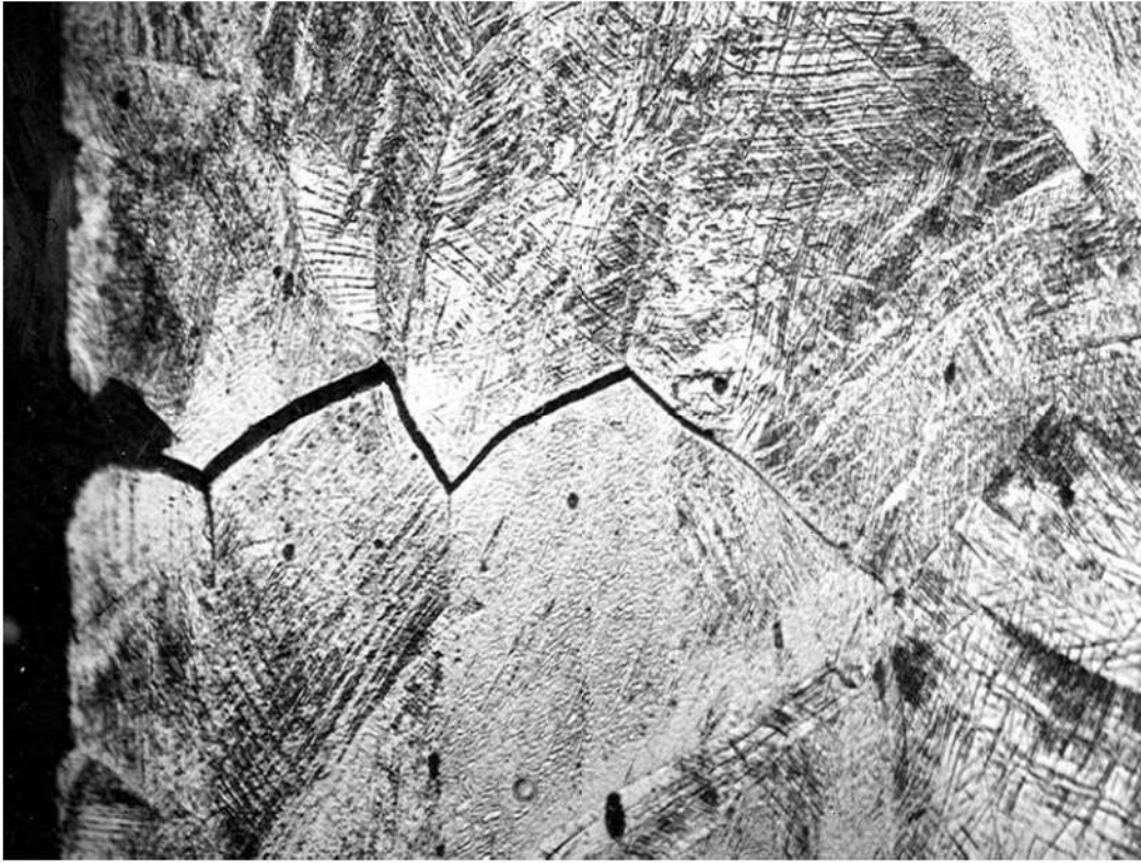
Figura 3. Microestructura del material, mostrando grieta intergranular en matriz de acero inoxidable austenítico de alta resistencia deformado plásticamente en frío, conteniendo austenita endurecida y martensita. Dureza Rockwell C = 36. Sección transversal. Reactivo de Vilella. 800X.
