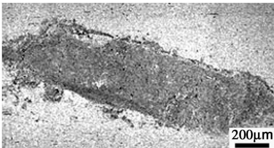
Figura 6. Marcas de fretting elípticas (alambre/alambre) observadas en la superficie externa de los alambres internos de aluminio cercanos a la superficie de fractura. MEB-BEI.
