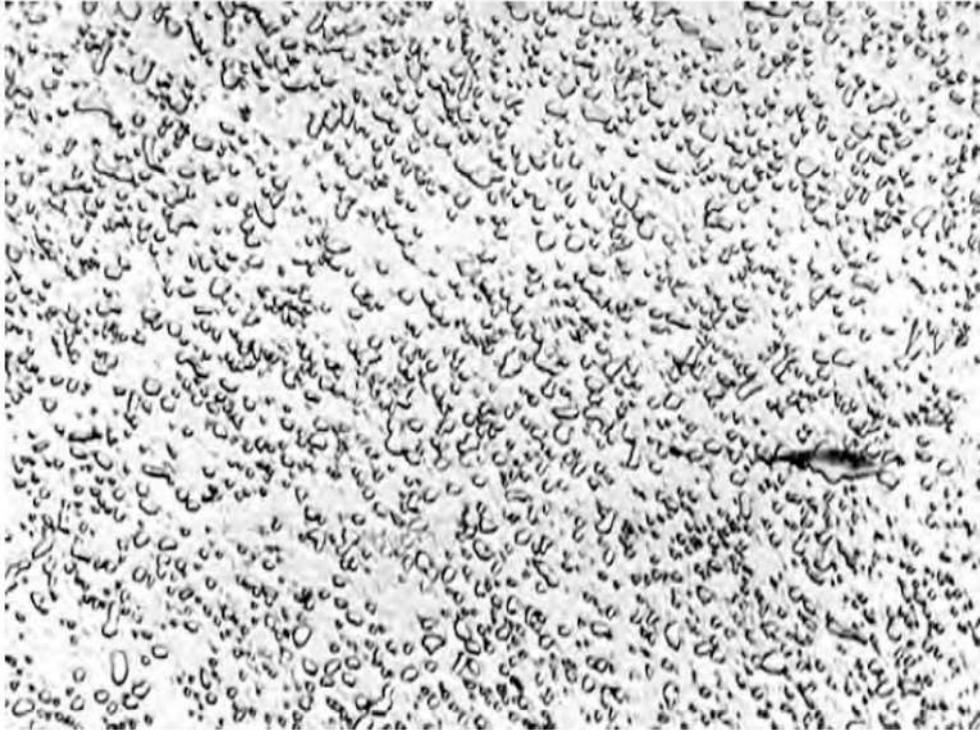
Figura 1. Barra de aço sueco. Glóbulos de cementita sobre um fundo de ferrita. Microestrutura de aço completamente coalescido. Reativo de ácido nítrico. 1.000X.
