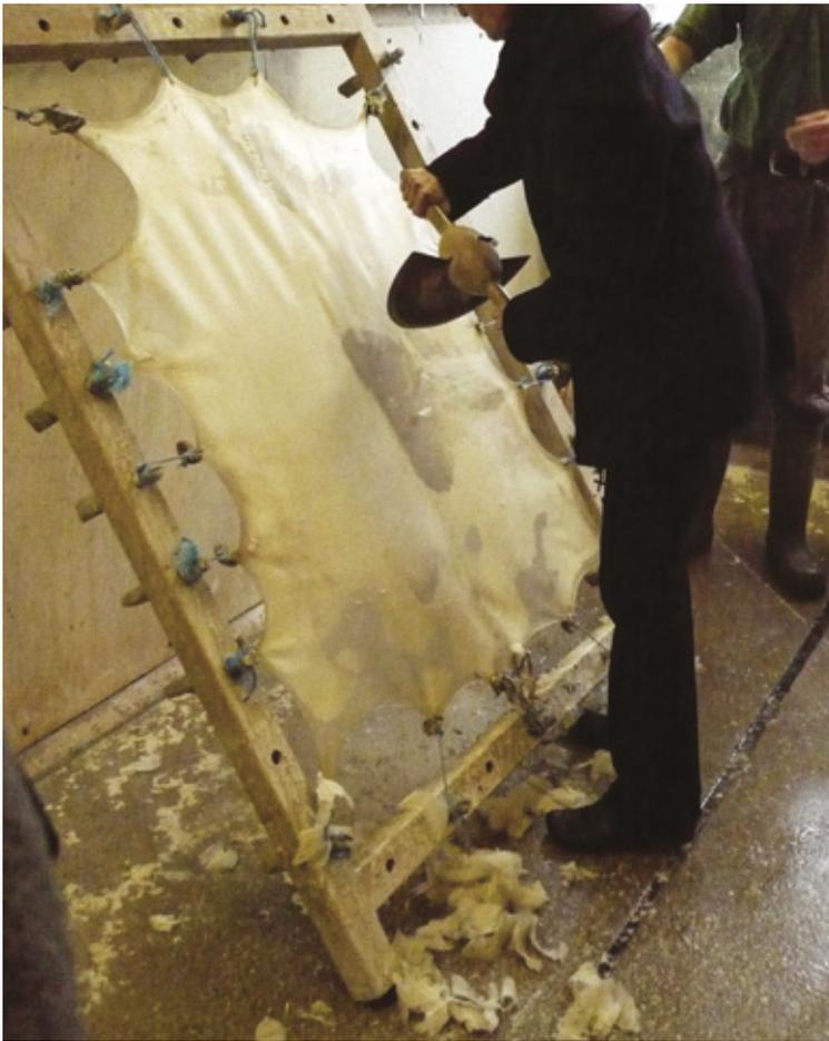
**FIG. 19.** Visita ao curtume inglês William Cowley: profissional chanfrando couro no processo tradicional, e ainda realizado, de fabricação de pergaminhos.
