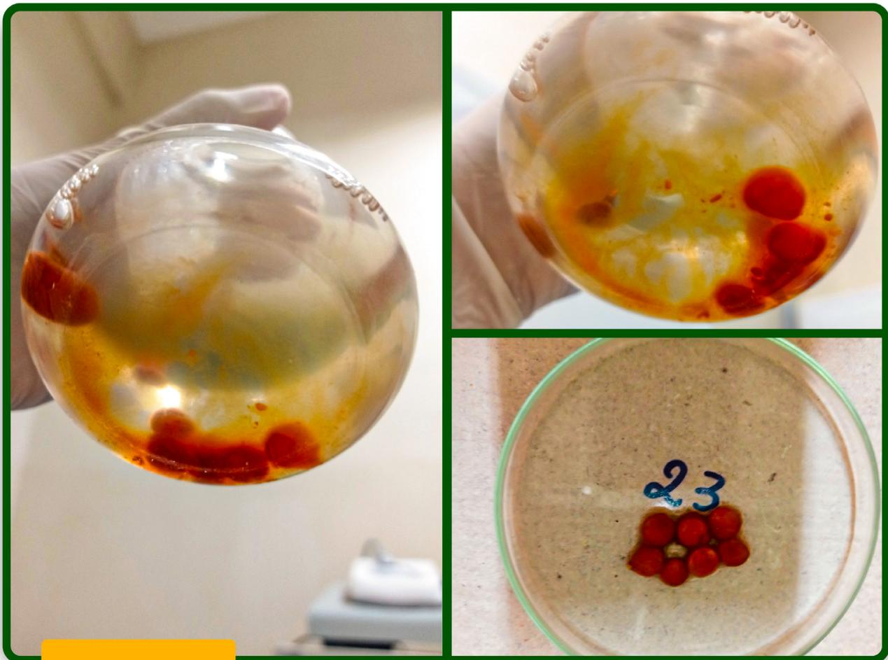
**Figura 13 - Processo de bioacumulação de EPTs através de discos do fungo *Pleurotus ostreatus* em amostras líquidas sintéticas.**
