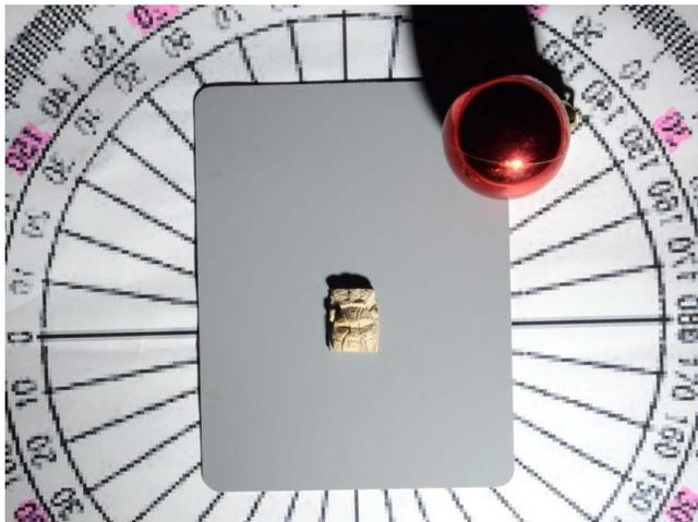
**Figura 19** - Uma das várias imagens produzidas em um processo de captura do RTI, exemplificando o que deve aparecer na captura.
