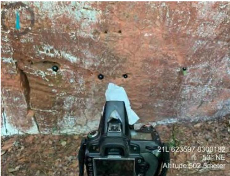
**Figura 103** - Pano inserido na saída do flash para difusão da luminosidade.
