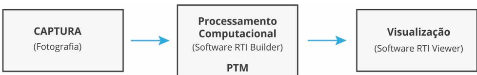
**Figura 2** - Fluxograma que representa o fluxo de trabalho de um processo de RTI.
