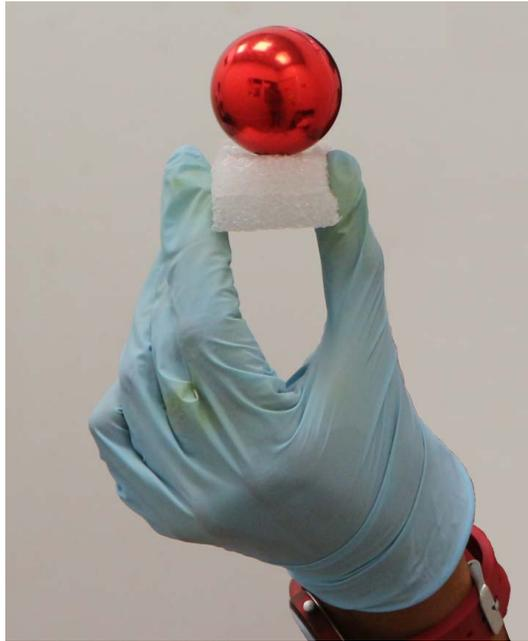
**Figura 17** - Bola decorativa natalina usada como objeto esférico reflexivo. Para sustentação, foi usado um pedaço de ethafoam escavado, no qual foi encaixado a argola da bola decorativa.
