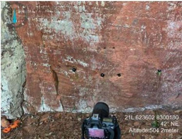
**Figura 102** - Delimitação do espaço do painel e posicionamento das esferas reflexivas.
