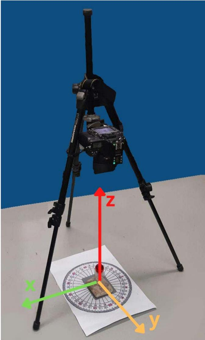
**Figura 25** - imagem esquematizando o sistema de coordenadas utilizado para localizar a luz.
