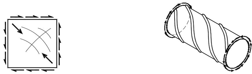
(a) Alma de barra de parede fina – ou placa      (b) Tubo de parede fina sujeito à torção
