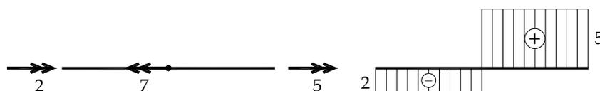
Figura 7.12 – (a) diagrama de corpo livre, (b) diagrama de momento torçor
