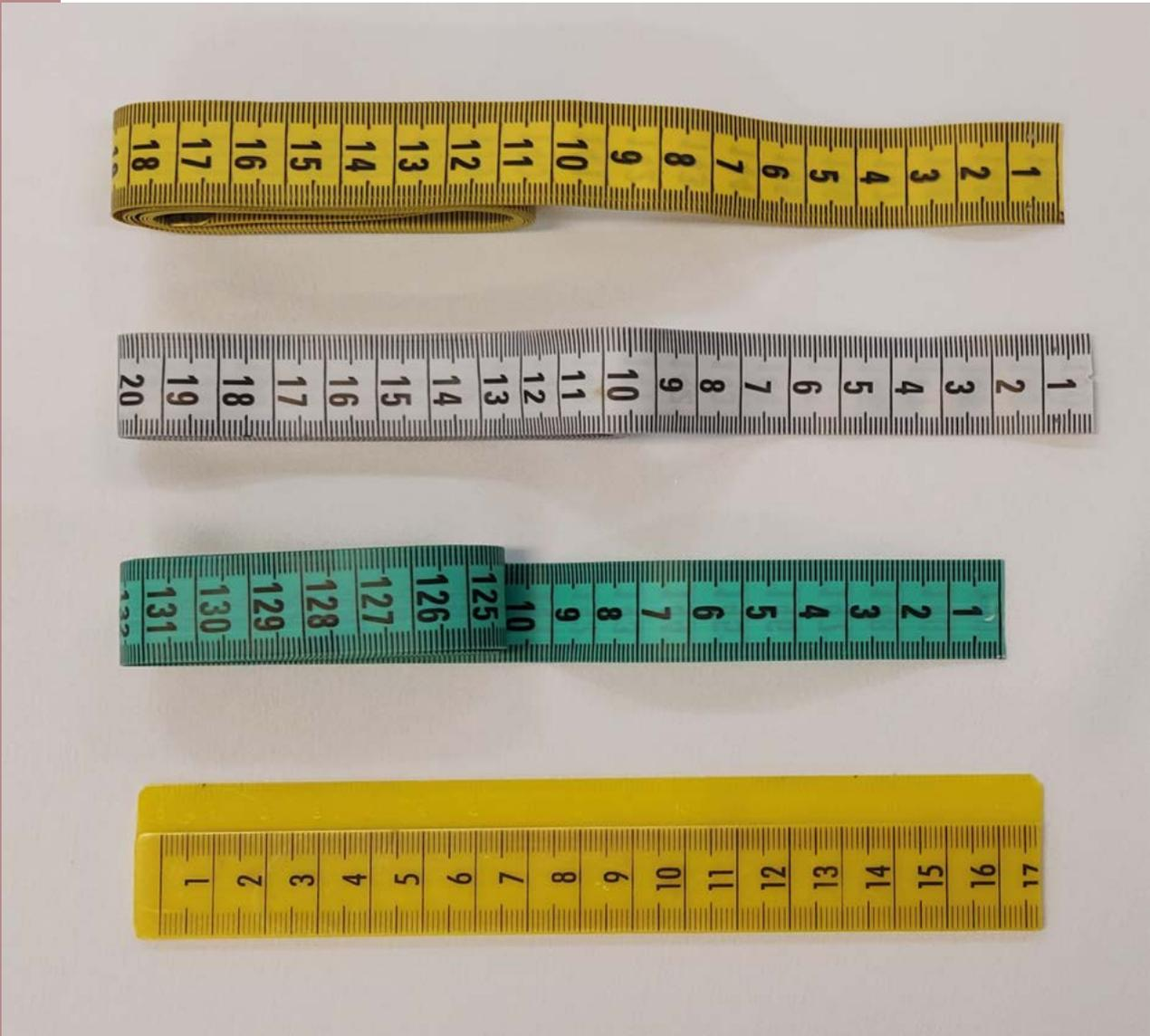
FIGURA 30 – Conjunto de fitas métricas e régua plásticas usado durante as medições de trajes
