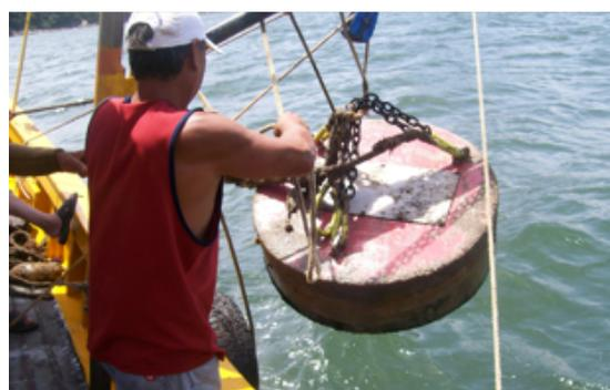
Fig. 7: Recolocação do ADCP para novo fundeio
