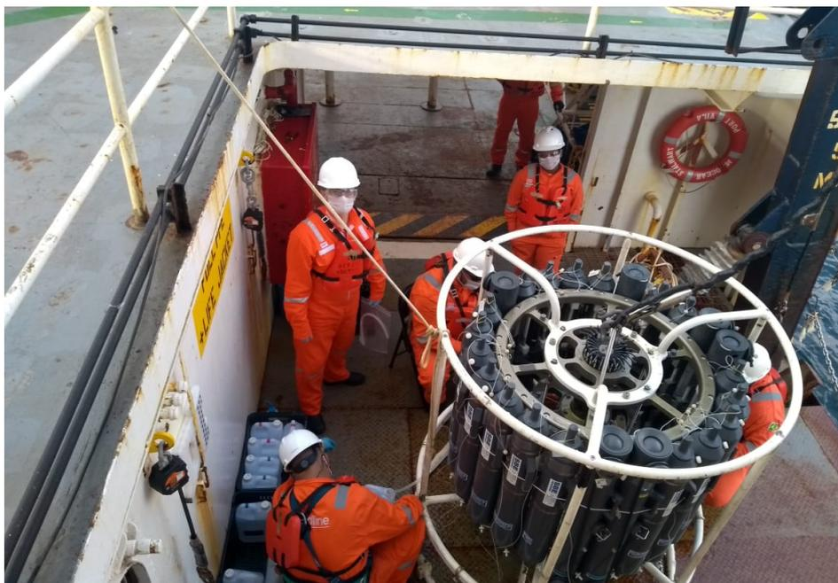
Fig. 45: Expedição oceanográfica a bordo do RV Ocean Stalwart equipado com sistema CTD Rossete e garrafas para coleta de água, com o objetivo de caracterizar a diversidade microbiana no sistema pelágico da Bacia de Santos, Oceano Atlântico Sudoeste. Projeto apoiado pela Petrobras
